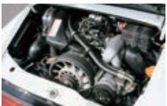
リアにエンジンを積んで、リアを駆動させるRR方式と水平対向エンジンを使い続けているポルシェ911。そこにポルシェとしての哲学がある。
